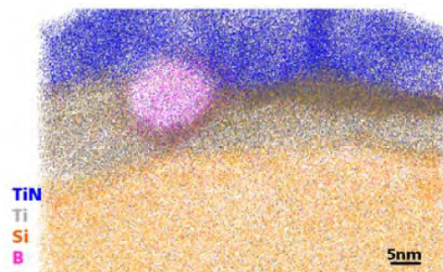
FIGURE 4.14 – Observation d'un précipité de bore à l'interface TiN/TiSi 2 par sonde atomique tomographique. Différentes couleurs sont utilisées pour cartographier chaque élément/molécule (27).
