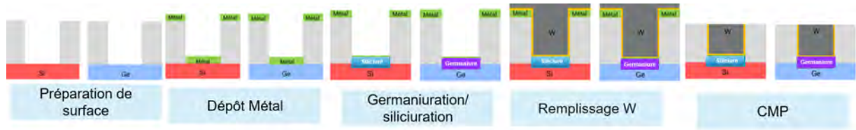
FIGURE 1.8 – Schéma des co-procédés à développer pour la co-intégration des contacts sur Si et Ge
