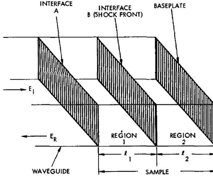
FIGURE 1.36 – Modélisation électromagnétique à deux couches lors du passage d'un choc par HAWKE *et al.* [75]
