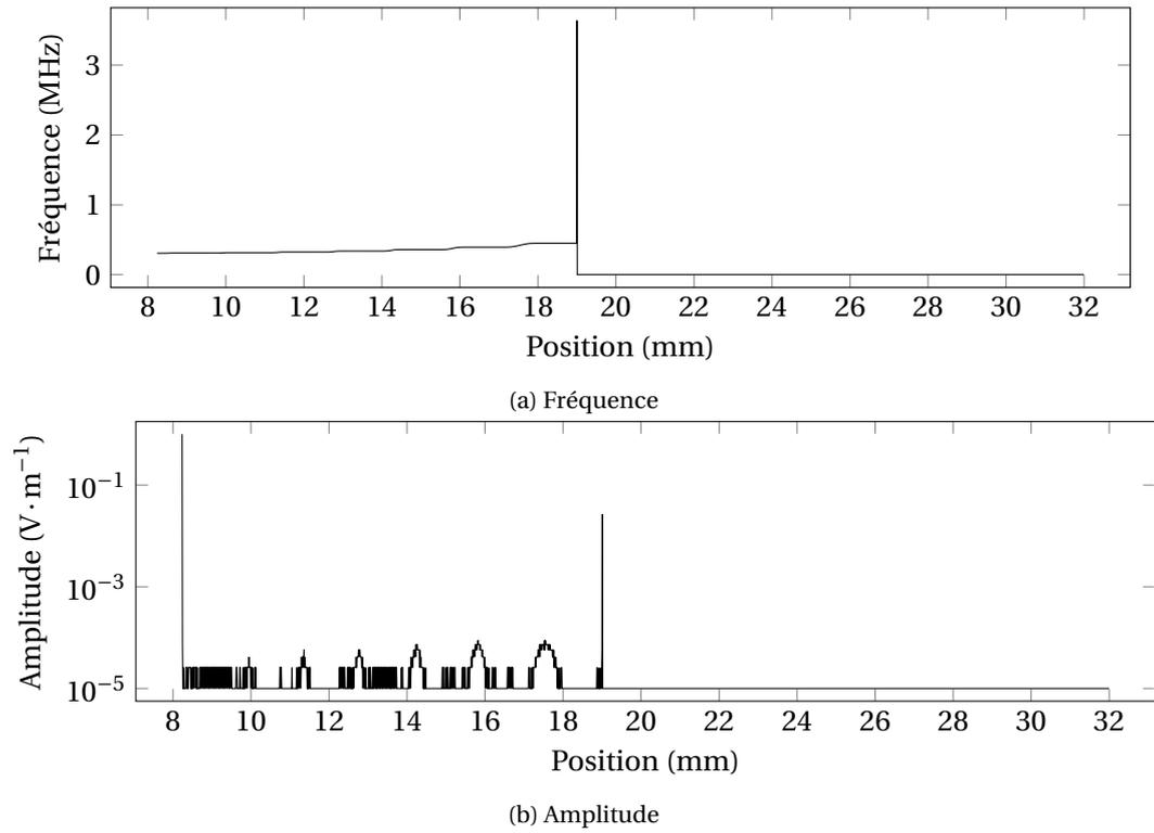
FIGURE 2.13 – Résultats en fréquence et en amplitude pour un impact Fer/PMMA avec le code GODLAG avec une vitesse d'impact de  $550 \text{ m} \cdot \text{s}^{-1}$  à  $t = 3,5 \mu\text{s}$  après l'impact
