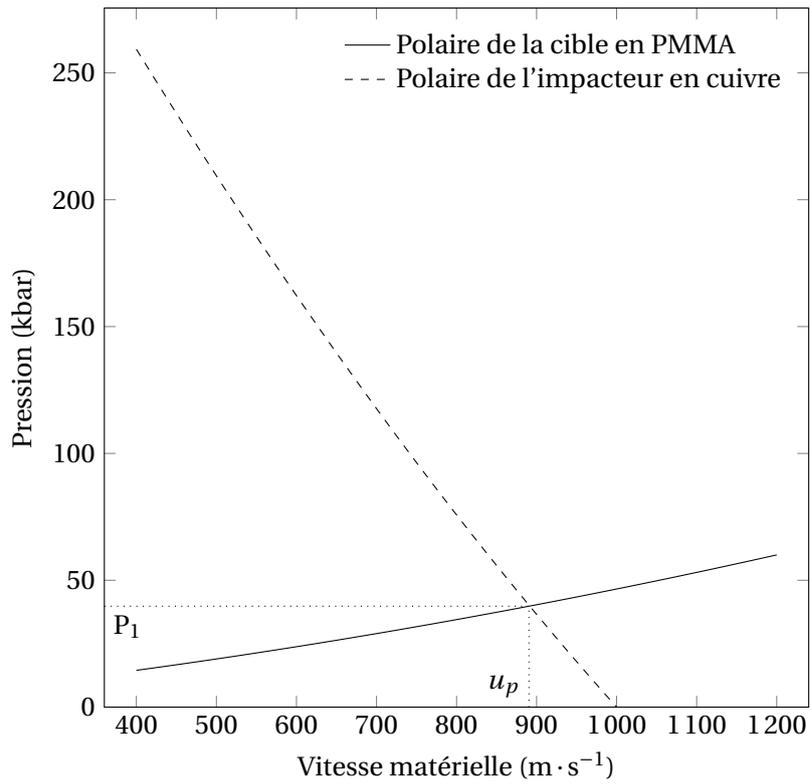
FIGURE 1.2 – Détermination graphique de la pression et la vitesse matérielle lors de l'impact d'un disque en cuivre sur une cible en PMMA à 1000 m·s<sup>-1</sup>
