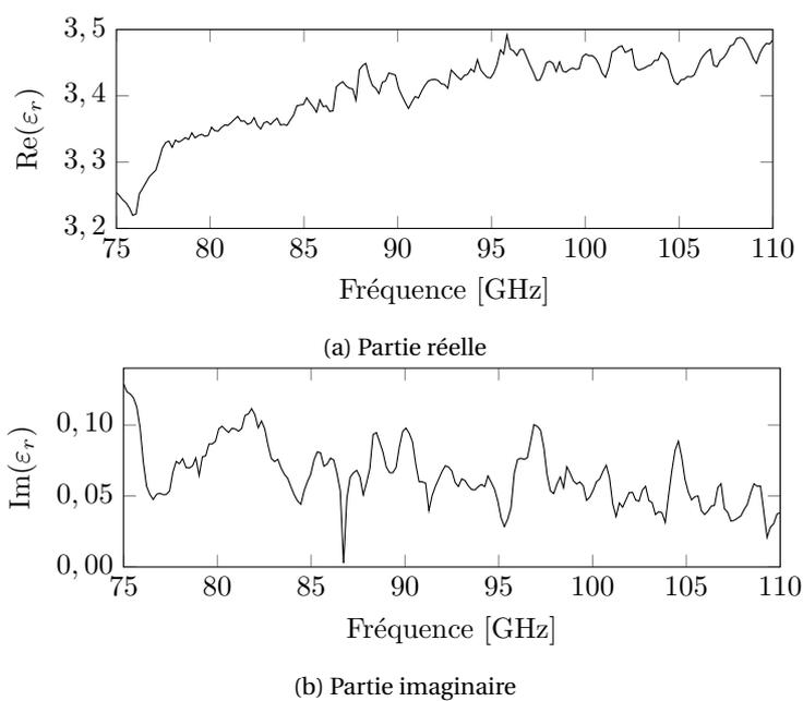
FIGURE C.14 – Permittivité complexe du mélange 2 de HMX-Liant inerte
