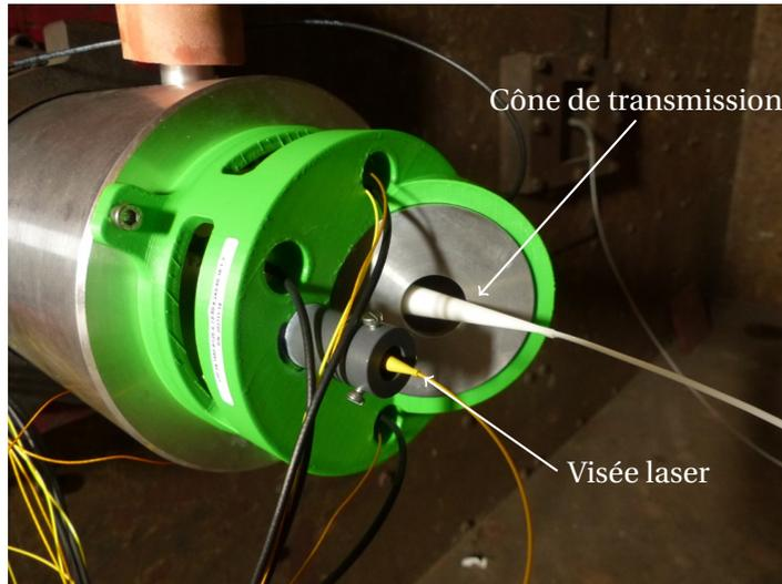
FIGURE 3.9 – Montage expérimental pour les essais sur l'ontalite
