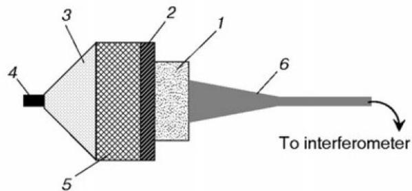
FIGURE 1.30 – Montage de BELSKII *et al.* [81] pour l'étude des doubles oscillations. 1 : échantillon; 2 : plaque de transfert métallique; 3 : générateur d'onde; 4 : détonateur; 5 : charge explosive; 6 : antenne et guide d'onde.
