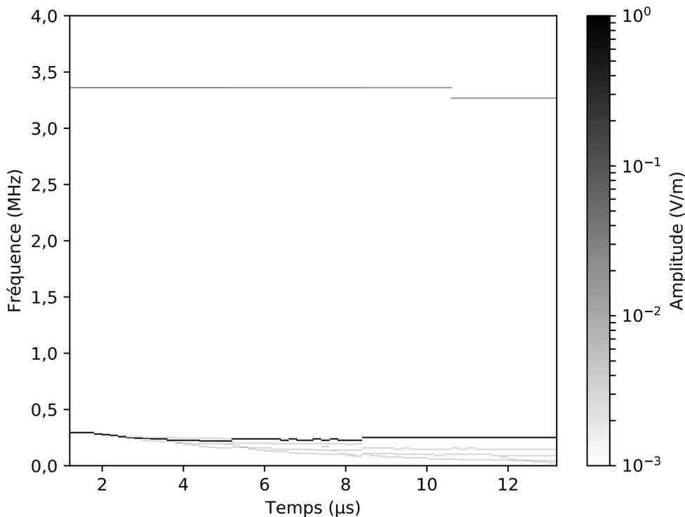
FIGURE 2.25 – Amplitude des fréquences du signal temporel réfléchi à l’ordonnée  $y = 20 \text{ mm}$  à la vitesse d’impact  $800 \text{ m} \cdot \text{s}^{-1}$
