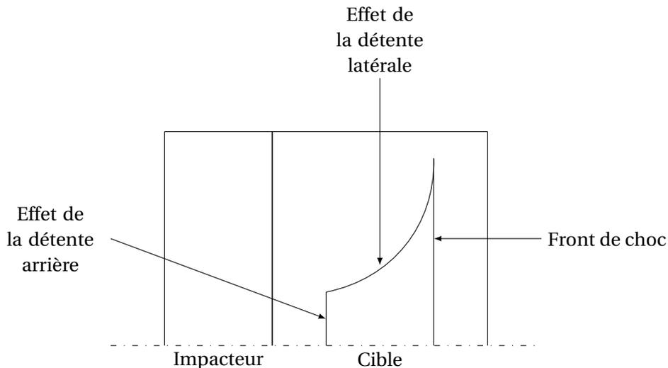
FIGURE 1.3 – Représentation des détente arrière et latérales
