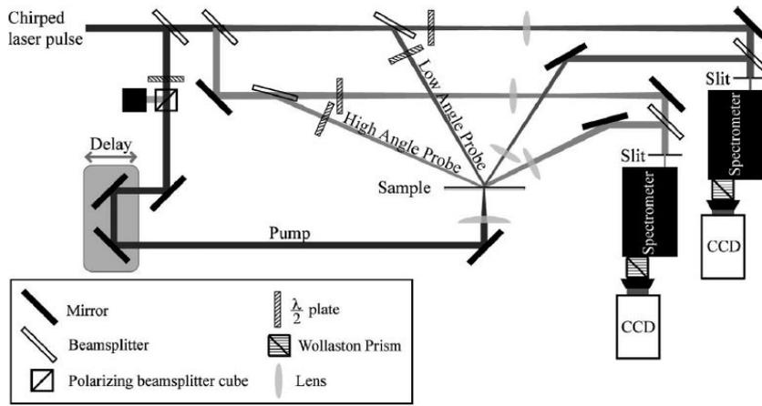
FIGURE 1.15 – Montage expérimental d'ellipsométrie dynamique [37]
