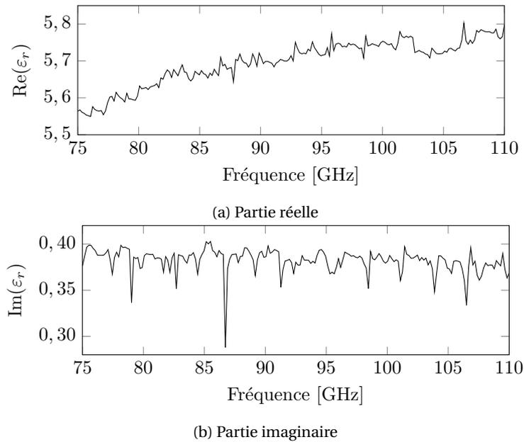
FIGURE C.10 – Permittivité complexe du mélange HMX-Aluminium-Liant inerte
