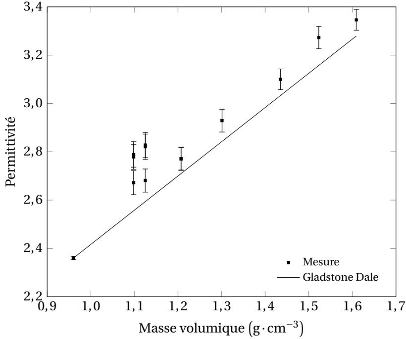
FIGURE 1.38 – Permittivité relative sous choc pour du polyéthylène [108] comparée avec le modèle de GLADSTONE DALE à 35 GHz
