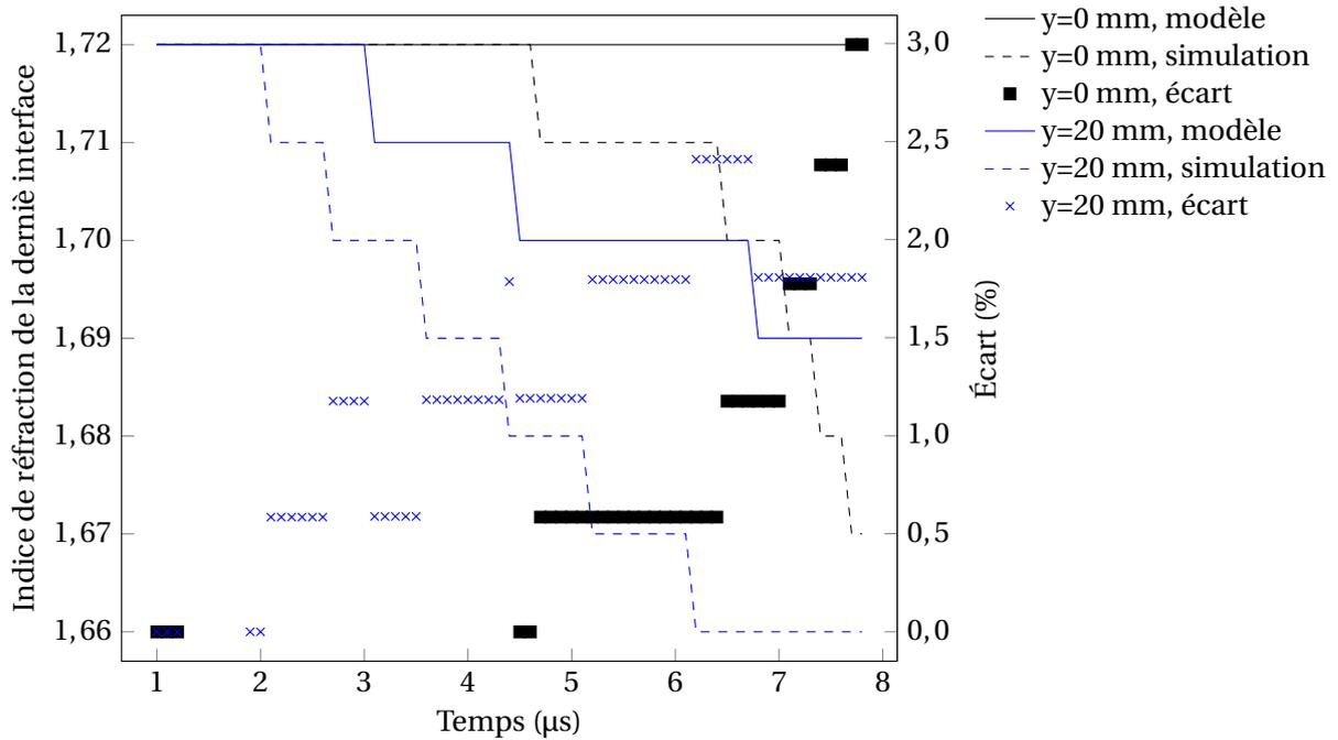
FIGURE 2.35 – Comparaison des indices de réfraction de la dernière couche obtenus par simulation hydrodynamique et par le modèle à deux couches avec le signal réfléchi calculé par le modèle à  $p$  couches pour  $y = 0$  mm et  $y = 20$  mm
