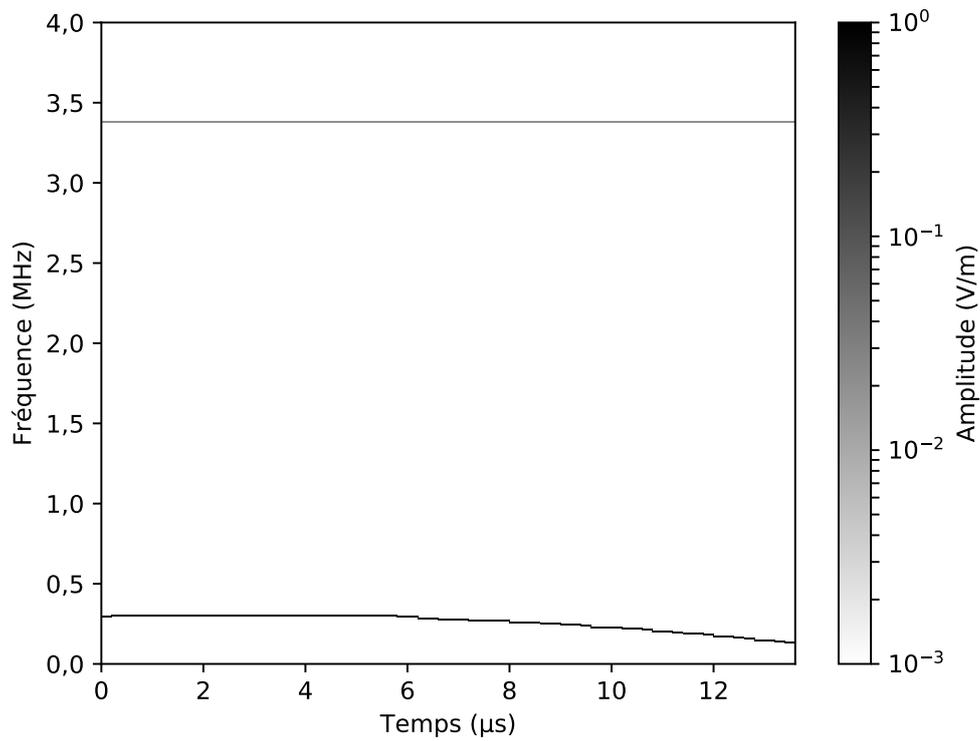
FIGURE 2.31 – Amplitude des fréquences du signal temporel réfléchi à l’ordonnée  $y = 5$  mm avec le modèle multi-couches
