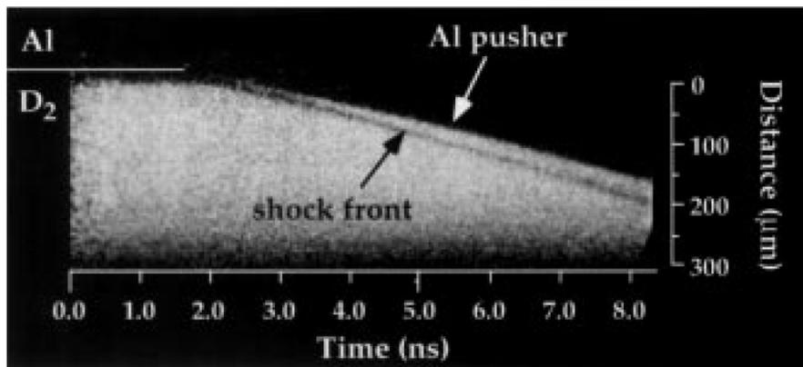
FIGURE 1.6 – Radiogramme obtenu avec une caméra à balayage de fente, position du choc dans du deutérium liquide à travers une plaque de transfert en aluminium en fonction du temps [18]
