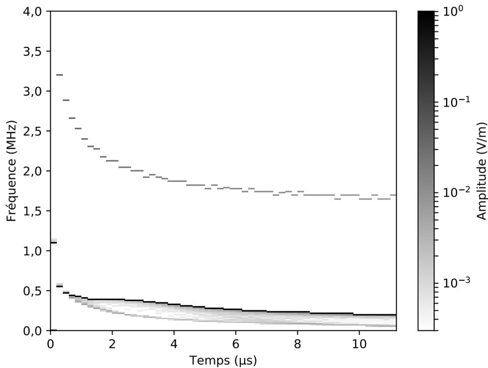
FIGURE 2.18 – Amplitude des fréquences du signal temporel réfléchi lors d'une détente arrière
