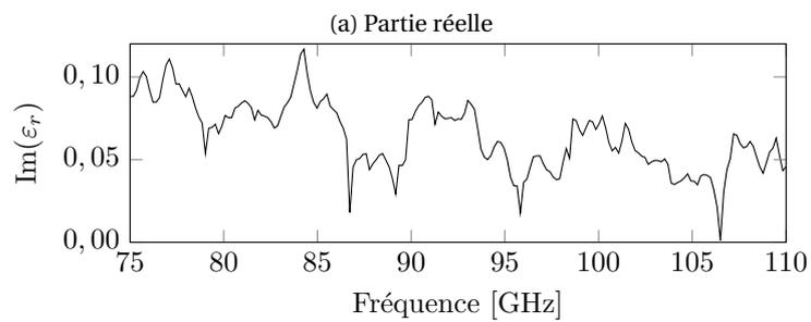
FIGURE C.13 – Permittivité complexe du mélange 1 de HMX-Liant inerte
