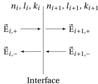
FIGURE 1.39 – Champs incidents et réfléchi par une interface
