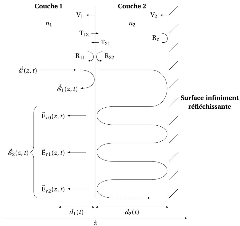
FIGURE 2.3 – Représentation et notations pour le calcul électromagnétique
