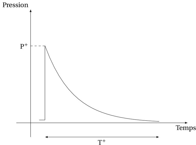
FIGURE 3.16 – Grandeurs pic-détente
