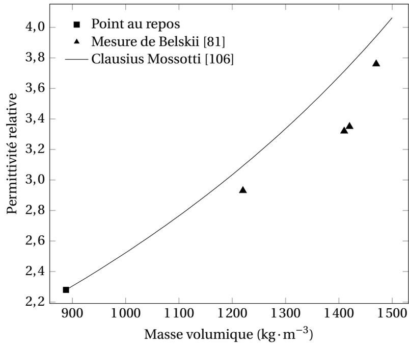
FIGURE 1.37 – Permittivité relative sous choc pour du benzène liquide [81] comparée avec le modèle de CLAUDIUS MOSSOTTI à 94 GHz
