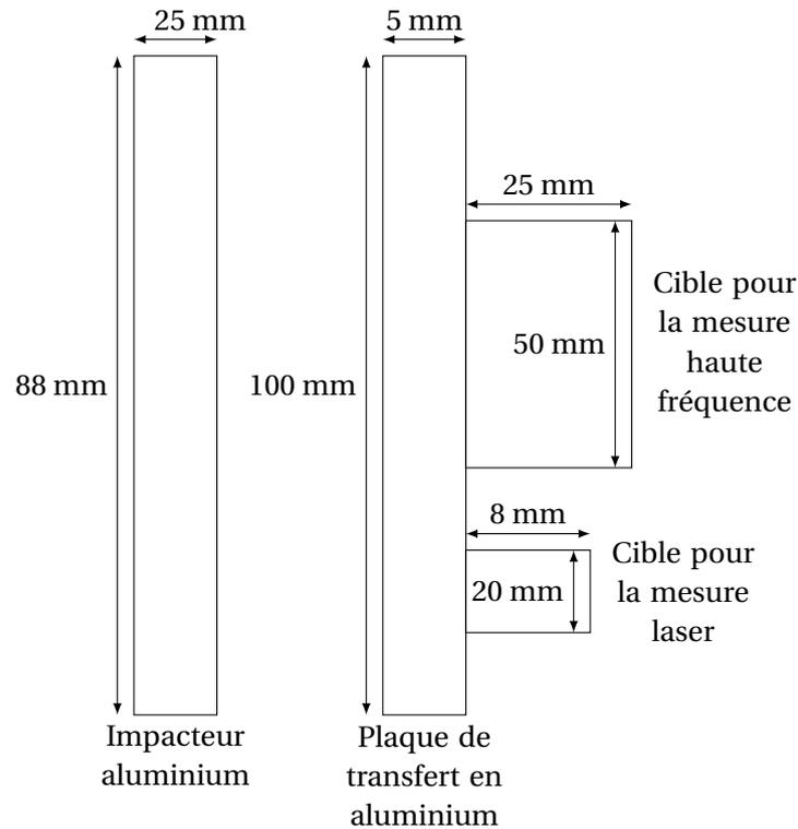
FIGURE 3.8 – Géométrie des essais sur l’ontalite
