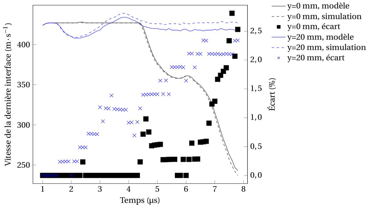
FIGURE 2.34 – Comparaison des vitesses de la dernière couche obtenues par simulation hydrodynamique et par le modèle à deux couches avec le signal réfléchi calculé par le modèle à  $p$  couches pour  $y = 0$  mm et  $y = 20$  mm
