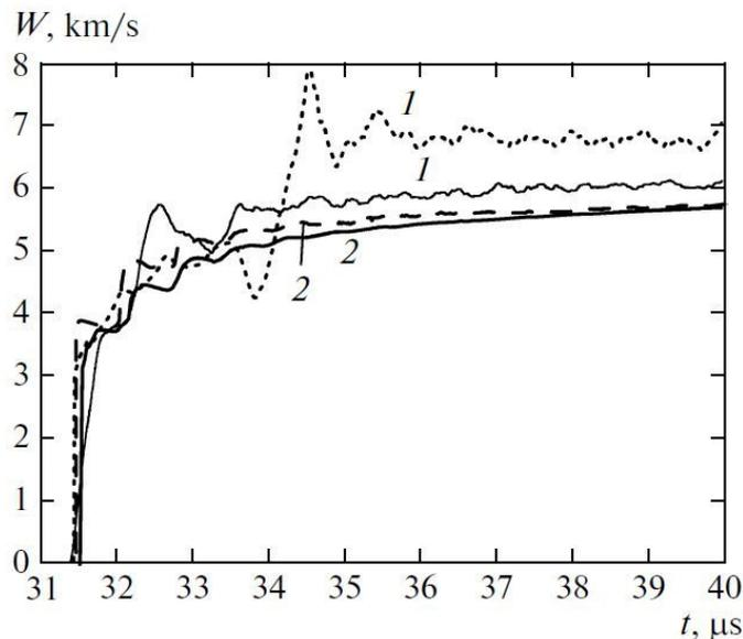
FIGURE 1.18 – Vitesse obtenue par OGORODNIKOV *et al.* [55] pour le déplacement d'une plaque en aluminium, les courbes indicées 1 sont les résultats d'interférométrie radio-fréquence, les courbes indicées 2 sont les résultats de l'interférométrie optique. Les traits en pointillés sont associés aux expériences réalisés dans de l'hélium, les traits pleins dans de l'air.
