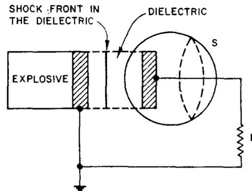
FIGURE 1.32 – Modélisation électrique du passage d'une onde de choc dans un matériau diélectrique [84]
