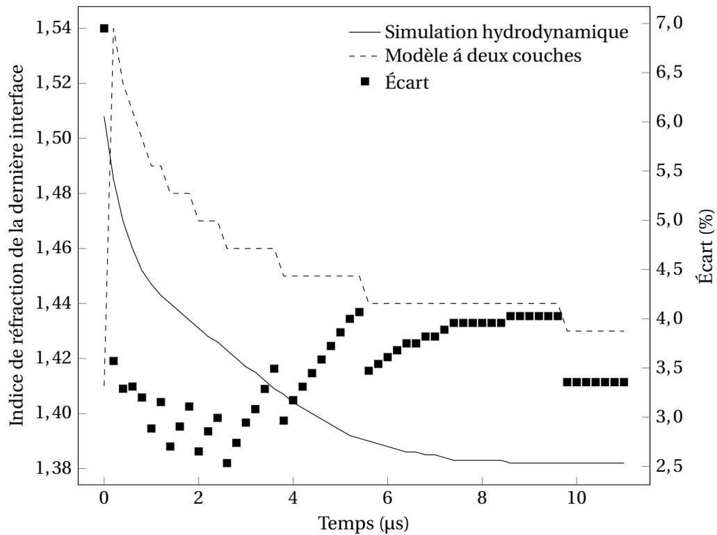
FIGURE 2.20 – Comparaison des indices de réfraction de la dernière couche obtenus par simulation hydrodynamique et par le modèle à deux couches avec le signal réfléchi calculé par le modèle à  $p$  couches
