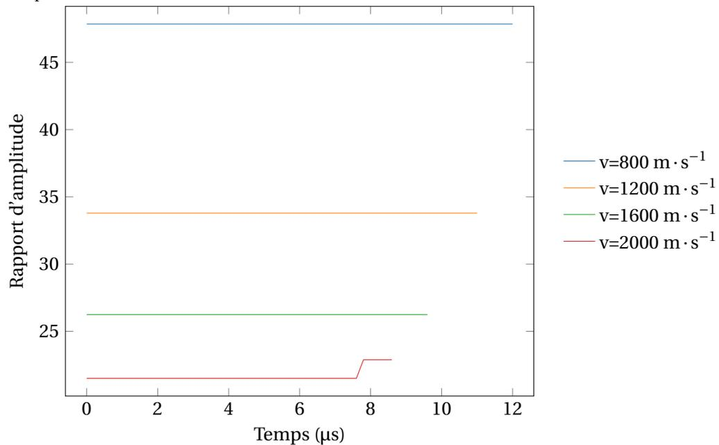
(b) Rapport d'amplitude en fonction du temps et de la vitesse d'impact
