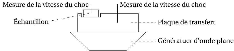
FIGURE 1.4 – Montage expérimental de DICK [10]
