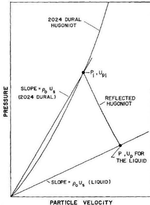
FIGURE 1.5 – Méthode d'impedance matching DICK [10]
