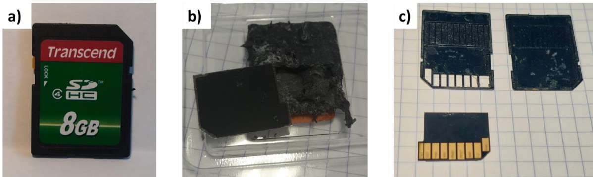
Figure 4.2 : Photos de la carte SD (a) telle que vendue et après ouverture du packaging plastique (b) face avant, (c) face arrière de la partie utile de la carte extraite du packaging plastique
