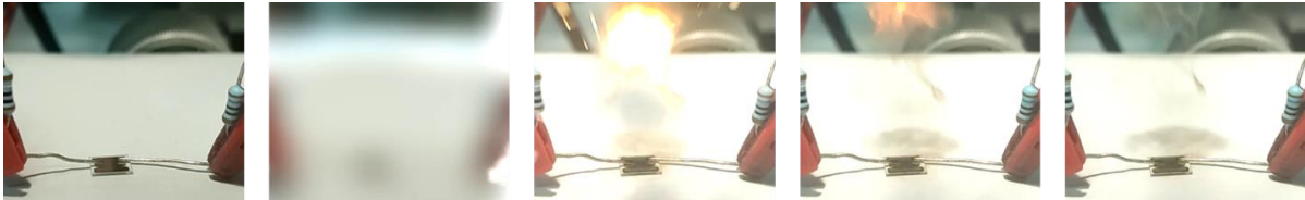
Figure 2.22 : Time lapse de l'initiation d'un NBW03
