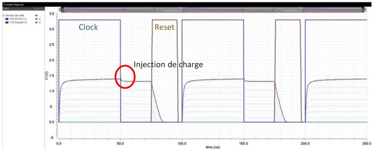
Figure III-25 : Régime transitoire de l'interrupteur NMOS, mise en évidence de l'injection de charges
