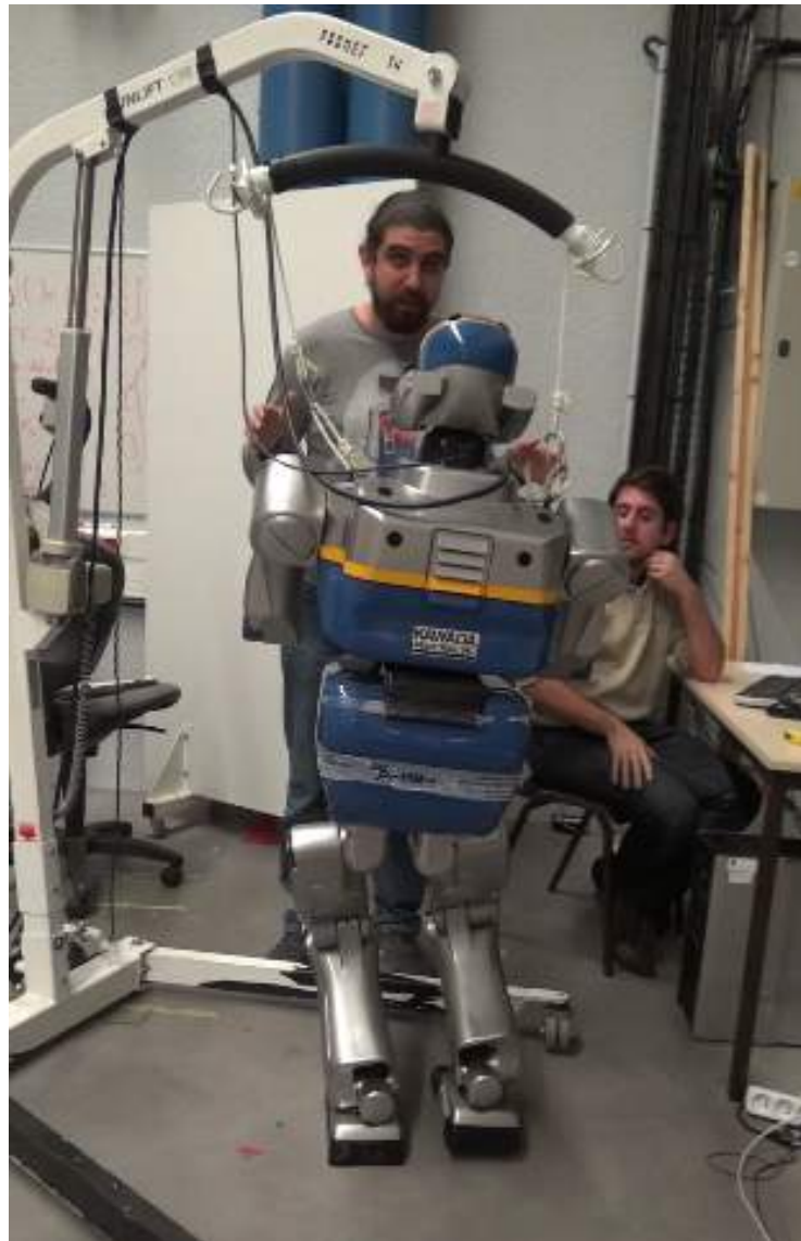
FIGURE 4.8 – Test du stabilisateur sur un pied.
