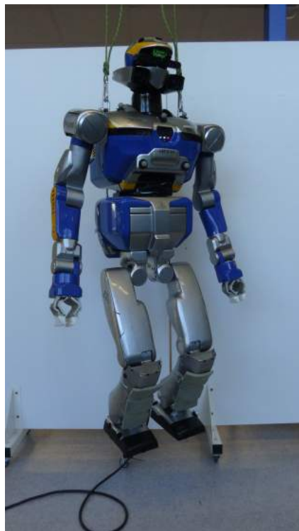
FIGURE 2.5 – Entre les différents tests, le robot HRP-2 peut être suspendu par des cordes au niveau des épaules.
