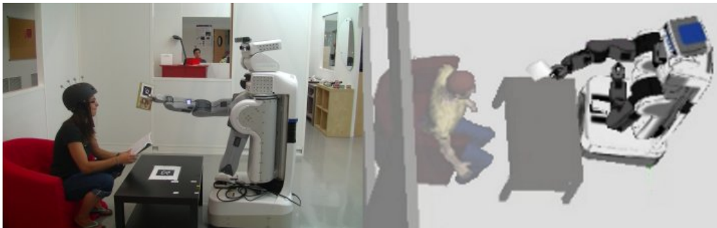
FIGURE 4.15 – Le robot réalise un "Bring" : il va chercher le DVD du Seigneur des Anneaux, le prends puis se déplace vers l'emplacement de l'homme pour lui donner.
