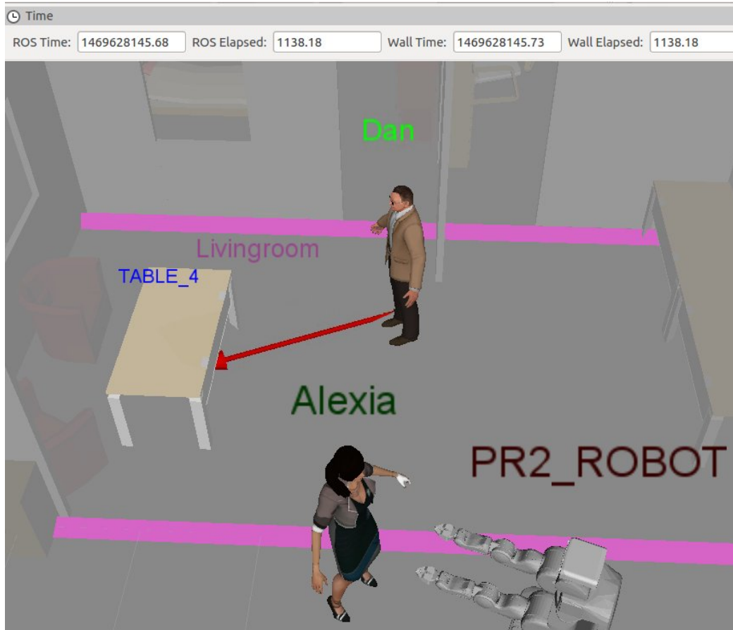
FIGURE 2.7 – Image issue de la visualisation de l'environnement et des faits TOASTER dans le module de visualisation Rviz. Le fait que Dan se déplace vers la table TABLE\_4 est représenté par une flèche rouge.
