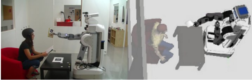
FIGURE 2.6 – Exemple d’environnement d’interaction homme robot (à gauche), et la représentation tridimensionnelle de cette même scène tel qu’elle est perçue par le robot (à droite). La représentation utilise les données collectées des capteurs pour positionner et orienter les divers éléments dans l’environnement 3d. La représentation faite utilise le nœud de visualisation de ROS : Rviz.
