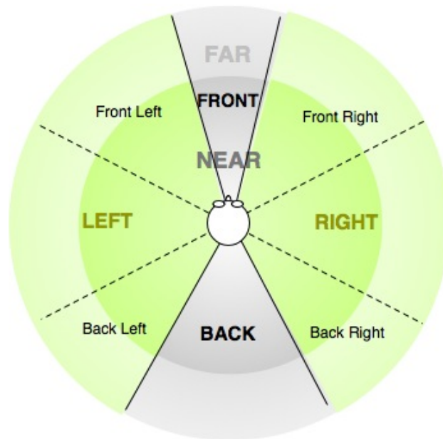
FIGURE 3.6 – Illustration du découpage géométrique pour désigner les emplacements en prenant l’homme comme référentiel. Cette illustration provient de la documentation de SPARK, un logiciel pour l’estimation de situation ayant été développé avant TOASTER : https://www.openrobots.org/wiki/spark/what_spark_computes .
