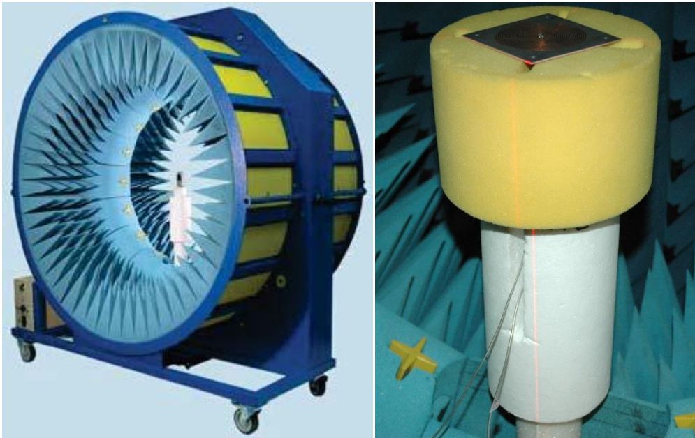
Figure IV-5: Illustration de la STARLAB de SATIMO (gauche) et photographie de l'antenne spirale lors de la mesure (droite)
