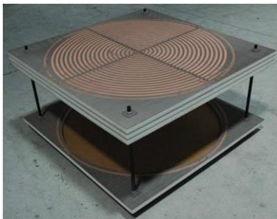
**Figure I-50: Prototype en VHF de l'antenne à 5 anneaux [I-51]**
