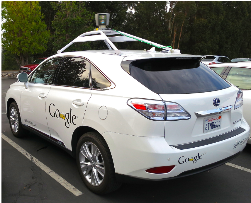
FIGURE 1.3 – Voiture autonome de Google sur une base de Lexus RX450h
