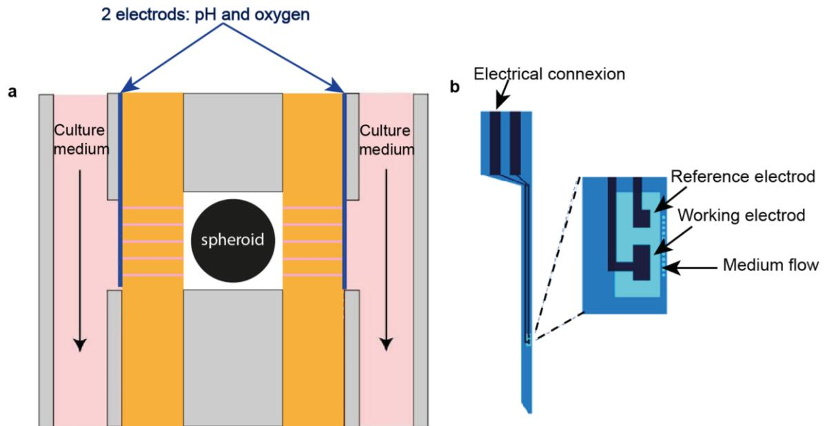
Figure 54 - a. Dispositif expérimental. b. Schématisation d'une électro-tigette.
