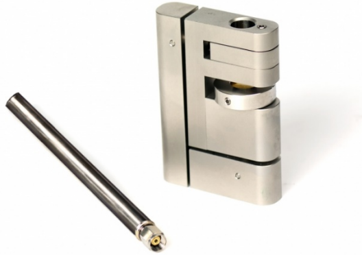
Figure 129: Sonde diélectrique utilisée avec son kit de calibration
