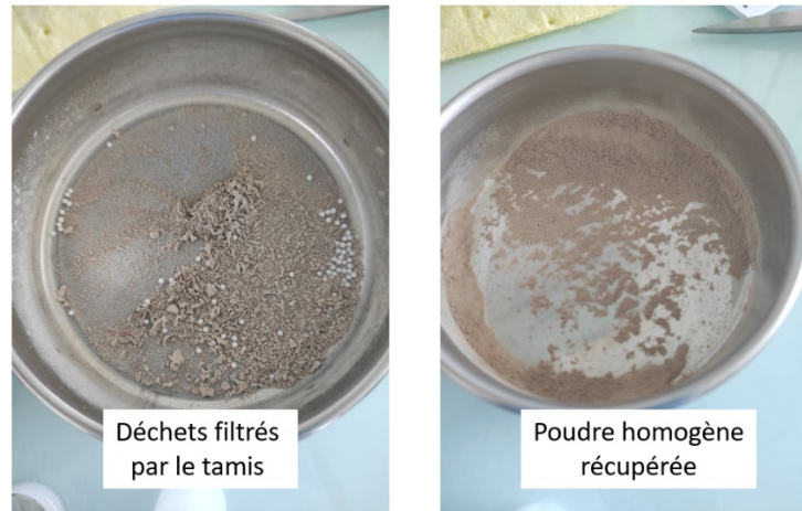
Figure 119: Tamis contenant les déchets (à gauche) et poudre filtrée grâce au tamis (à droite)
