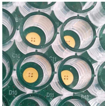
Figure 29 : Photographie d'un îlot avec plaque à puits positionné au-dessus
