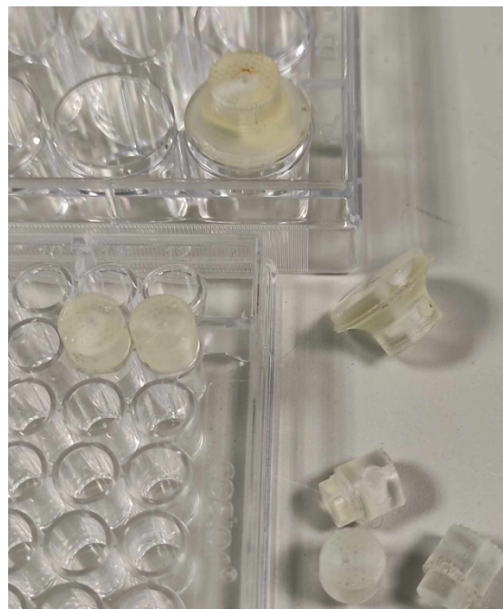
Figure 51: Images des bouchons 96 puits et 24 puits imprimés en résine
