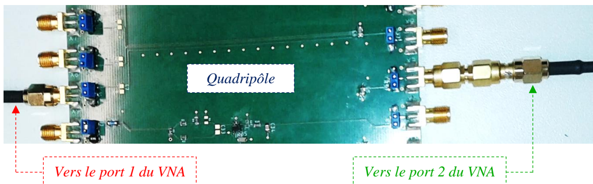
Figure III.4 – Mesure directe sur les 2 ports du quadripôle
