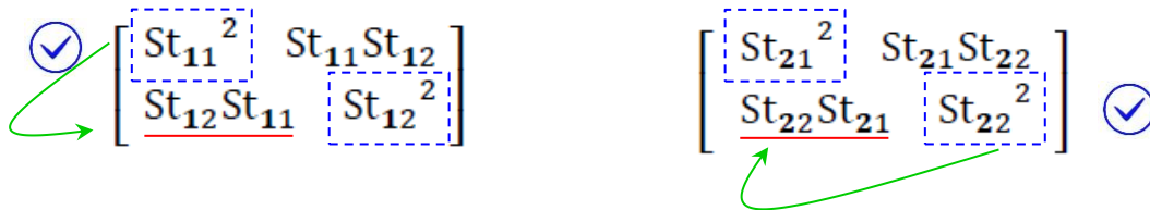
Figure III.17 – Relation de dépendance entre les paramètres de (III.25) : exemple d'un réseau 2 ports
