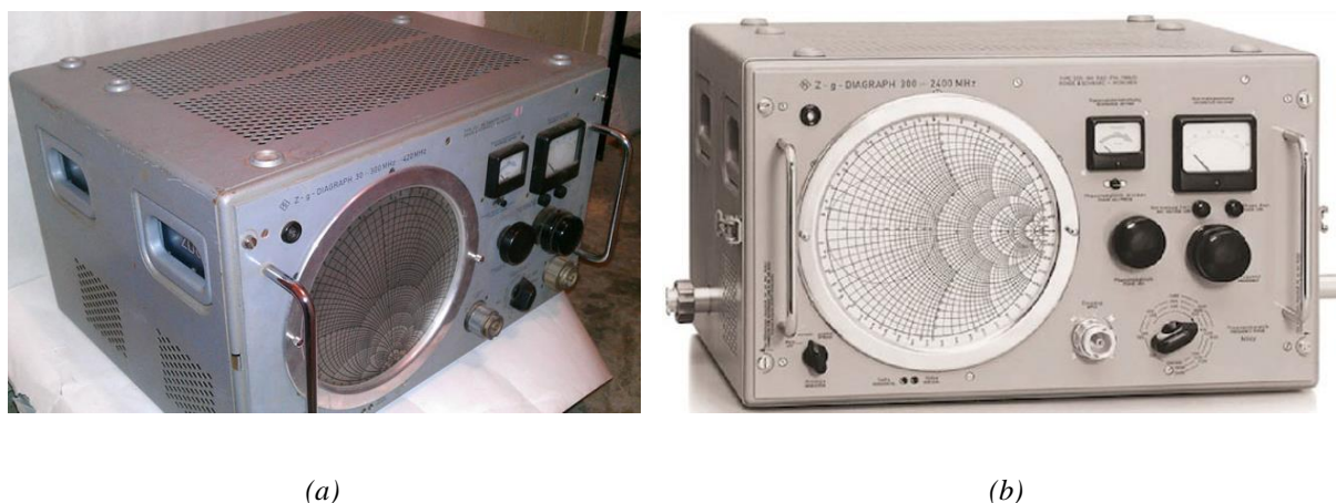
Figure II.3 – Premiers analyseurs de réseaux vectoriels au monde (de Rohde & Schwarz) : (a) Z-g Diagraph ZDU ; (b) Z-g Diagraph ZDD [47]
