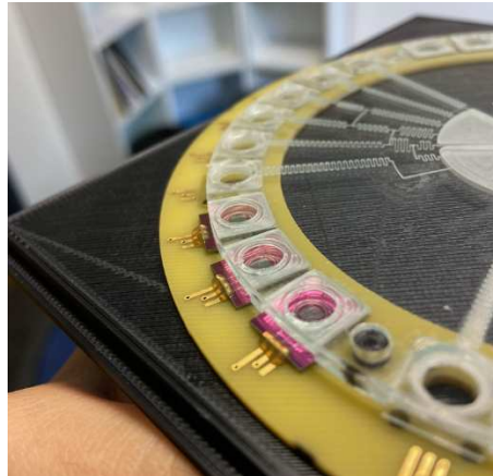
Figure 2.13 : Photographie des capteurs montés sur disque en vue de l'application finale
