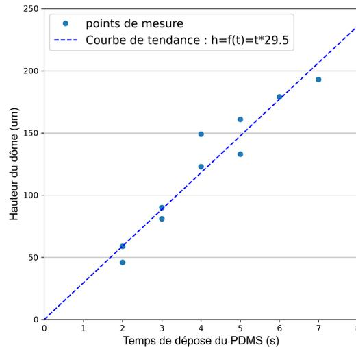
(b) Graphique des hauteurs des dômes de PDMS en fonction du temps sur des lamelles de  $1 \text{ mm} \cdot 1 \text{ mm}$ . PDMS déposé à 1 bar de pression, avec une pointe de seringue de gauge 27, avec l'appareil Tresky
