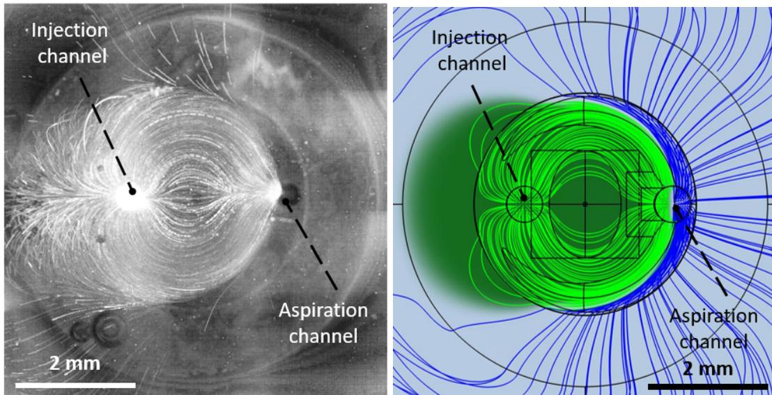
(a) Expérience de confinement du fluide injecté. Vue en fluorescence d'une solution de PEGDA avec microparticules fluorescentes de 5  $\mu\text{m}$  en exposition longue (b) Simulation de la situation comparable à la figure (a)
