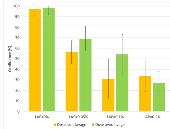
FIGURE 6.8 – Étude de l'impact du changement du milieu à  $t=7h$  sur la viabilité cellulaire de PC3 après insolation de la solution contenant du LAP et les cellules en suspension. Insolation à 40 mJ/cm<sup>2</sup> à  $t_0$ , changement du milieu à 7h, mesures à 79h.
