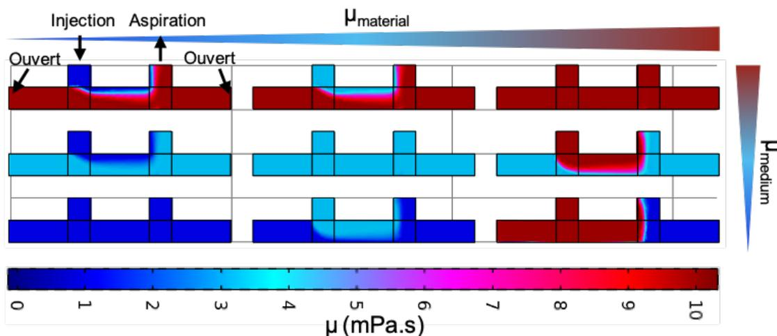
(a) Viscosités des solutions du milieu et injecté.  $\mu_{med}$  est croissant des simulations du bas vers le haut,  $\mu_{mat}$  est croissant des simulations de gauche vers la droite. Valeurs aux limites : 1, 3.16, 10 mPa.s.
