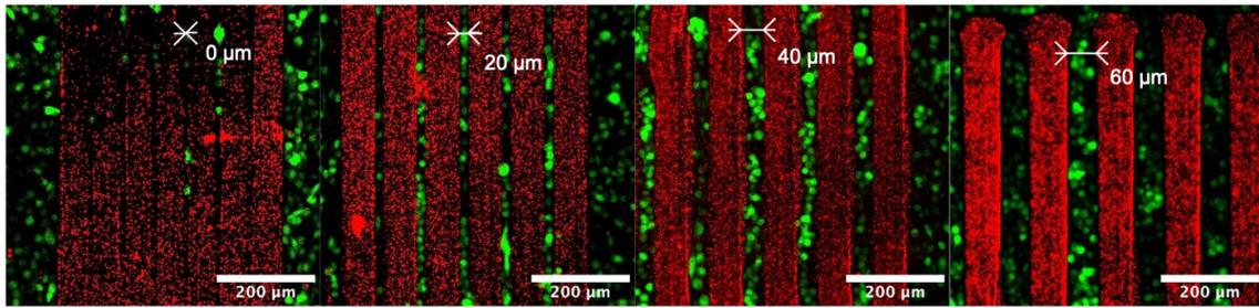
(a) Comparaison de la prolifération des cellules en fonction de l'écart entre les réseaux de lignes. De gauche à droite, l'espace inter-lignes est large de 0  $\mu\text{m}$ , 20  $\mu\text{m}$ , 40  $\mu\text{m}$  et 60  $\mu\text{m}$ . Rapport d'aspect de 0.8.
