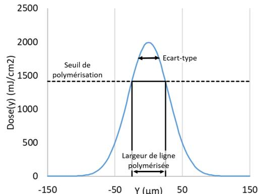
(b) Diagramme d'une gaussienne correspond à l'équation 5.6, avec  $P_{out} = 0.3 \text{ mW}$ ,  $\sigma = 30 \text{ µm}$ ,  $V = 0.2 \text{ mm/s}$  et  $Dose_{seuil} = 1410 \text{ mJ/cm}^2$
