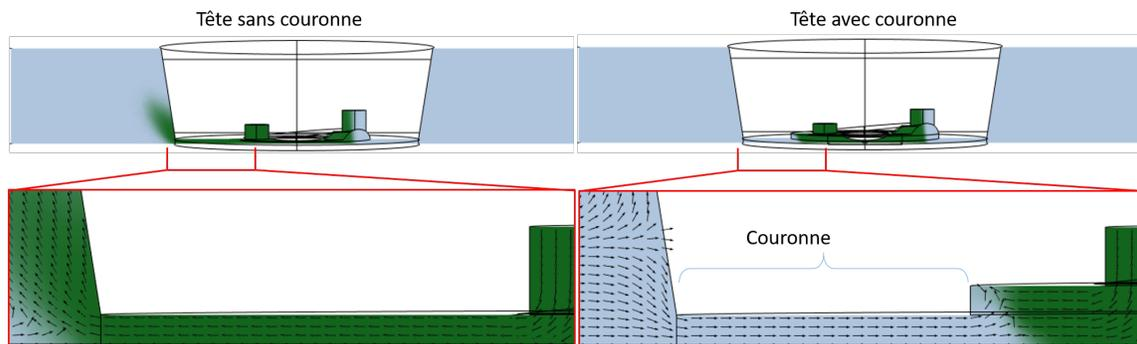
FIGURE 4.12 – Coupes dans le plan XZ de la concentration en solution injectée avec et sans couronne à la surface de la tête. Cas 1 sans couronne : le dôme mesure 20  $\mu\text{m}$ . Cas 2 avec couronne : la couronne mesure 100  $\mu\text{m}$  de haut et le dôme 120  $\mu\text{m}$ . Cas 1 et 2 : distance dôme - substrat = 100  $\mu\text{m}$ . Solution injectée en vert dans le milieu bleu.  $V = 0.1 \text{ mm/s}$ ,  $\mu_{med} = \mu_{mat} = 1 \text{ mPa.s}$ ,  $R_\phi = 2.5$ .
