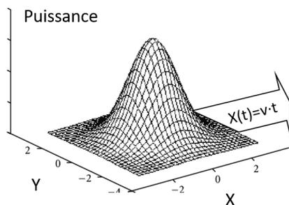
(a) Schéma du déplacement d'une gaussienne 2D suivant l'axe  $x$
