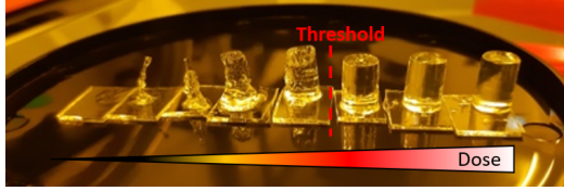
(a) Image de cylindres de PEGDA polymérisés avec lumière collimatée dans une plaque de 96 puits avec une dose croissante
