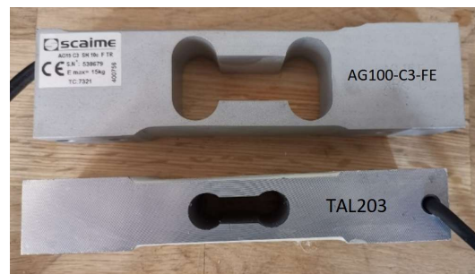
FIGURE 2.12 – Image des corps d'épreuve équipés des jauges de contraintes
