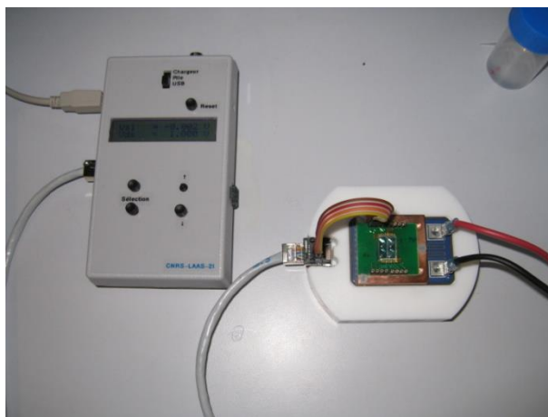
Figure 11 : ISFETmètre à gauche et plateforme Peltier à droite, sur laquelle est posée la plateforme multicateurs ISFET
