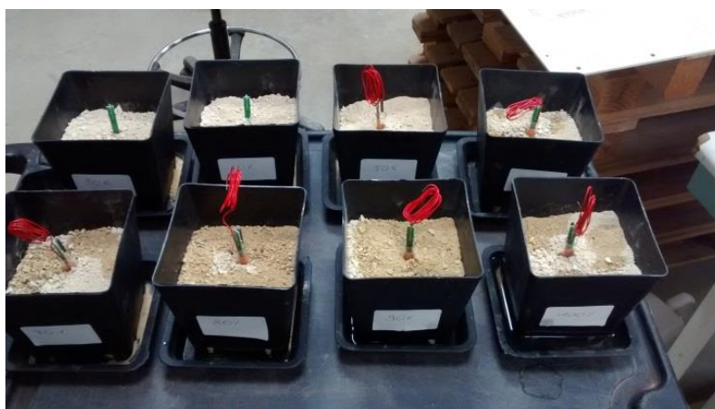
Figure 19 : Photo d'une campagne de mesure in-situ des capteurs pH-ISFET en sol argilo-limoneux dont l'humidité variait de 30 à 100% de la capacité maximale de rétention d'eau.
