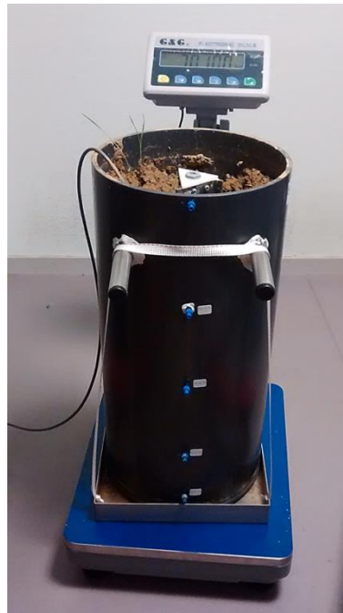
Figure 27 : Photo du banc d'essai positionné sur la balance (les connecteurs des lysimètres apparaissent en bleu le long du tube)
