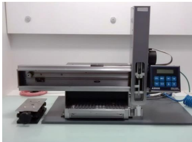
Figure 4 : Machine de dispense pour le dépôt de membrane sur la zone sensible d'un ISFET
