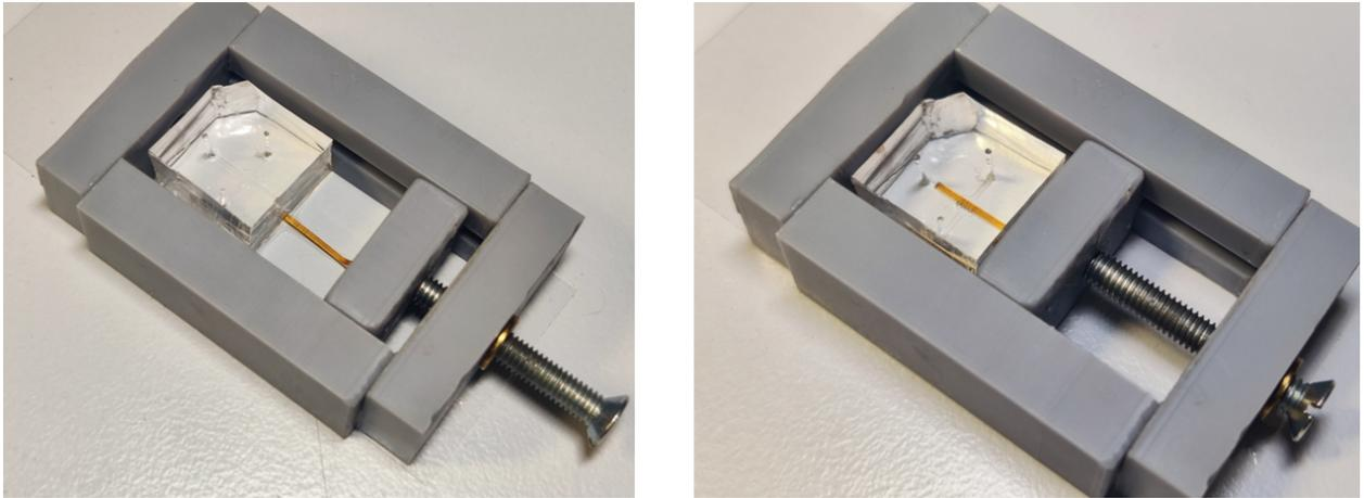
FIGURE A.13 – Image d'un dispositif conçu pour l'insertion précise de la tigette à l'intérieur de la puce.
