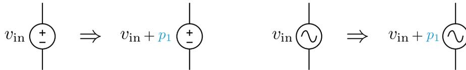
FIGURE 2.4 – Modélisation d'une perturbation sur des sources de tension
