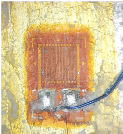
(a) Peigne central de la jauge de contrainte – compensation thermique T1 et T2
