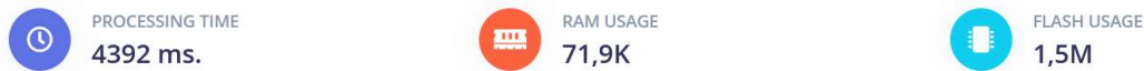
FIGURE 4.10 – Temps de calcul et ressources nécessaires pour exécuter le modèle sur une cible nRF52
